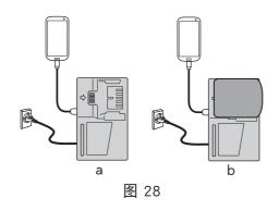
(2) 连接 USB 线缆。(图 29) 拔下橡胶盖并将市售的 USB 线缆(匹配充电的设备) 紧紧插入 USB 端口。
