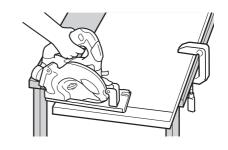
手部支撑、工件支撑和布线图示。 图 1
