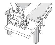
手部支撑、工件支撑和布线图示。 图 1
