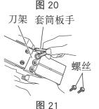
(6)如图 27 所示,将刀架置于已完成组件之上,并用 3 个螺栓固定之。务请拧紧螺栓。对反侧的炭化刃也请按相同方法进行。
