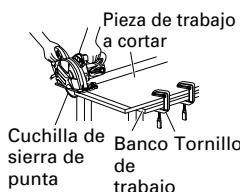
El borde externo de la cuchilla de sierra de punta se proyecta de la parte inferior de la pieza de trabajo a cortar. Por lo tanto, el material debe colocarse sobre un banco de trabajo cuando se corte.
