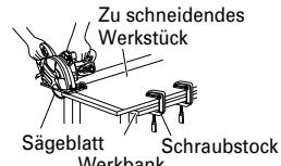
Der Außenrand des Sägeblattes ragt aus der Unterseite des Werkstücks, das geschnitten wird, hervor. Daher sollte das Material beim Schneiden auf einer Werkbank aufgelegt werden. Außerdem sollte darauf geachtet werden, dass die Sägezähne des Sägeblatts und die untere Führung nicht in Berührung mit der Fläche unter dem Werkstück (d. h. der Fläche der Werkbank, der Erde, dem Boden usw.) kommen. Um sicher zu
