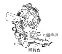
将回转台左右移动,松开侧 手柄并将其调到合适位置。
